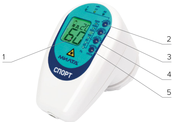
Рис. 6. Панель управления работой светолазерного терапевтического аппарата МИЛТА СПОРТ: 1 – индикация на табло экспозиции (времени процедуры) в минутах, 2 – кнопка регулирования интенсивности светодиодного излучения ИК-диапазона, 3 – кнопка регуляции импульсной мощности лазерных излучателей, 4 – кнопка выбора частоты генерации импульсов лазерных излучателей, 5 – кнопка выбора значений экспозиции; совмещена с функцией запуска и остановки работы аппарата
